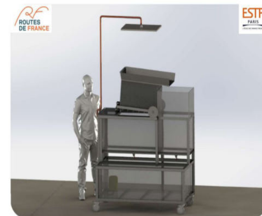
Outil de mesure du coefficient de ruissellement Conception ESTP / Routes de France
