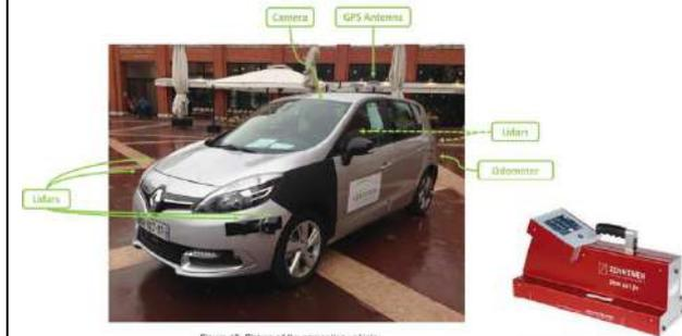
Parmi les 7 marquages de chaussée actuellement évalués, les résultats préliminaires indiquent que le marquage haute performance (RL > 1000 mcd/lux/m<sup>2</sup>) est le plus lisible de nuit par notre système de mesure par caméra et par les conducteurs.
